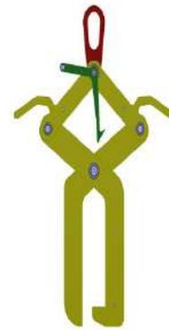
**Pinza:** dispositivo utilizzato per movimentare carichi mediante il serraggio su una parte specifica del carico - noto anche come pinza.
