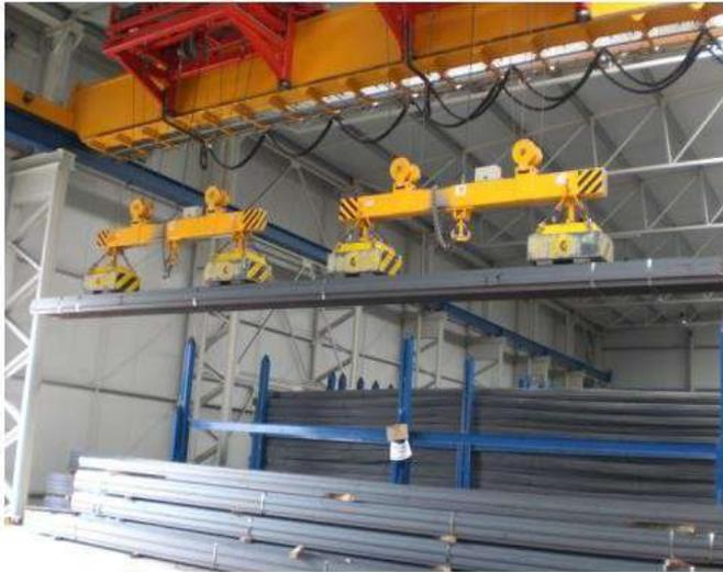
Traversa con Elettromagneti
